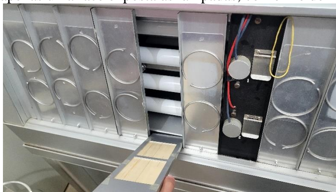
Figura 2: Madeira de marupá acoplada e travada, com sua face exposta para as lâmpadas que emitiram a radiação ultravioleta.
