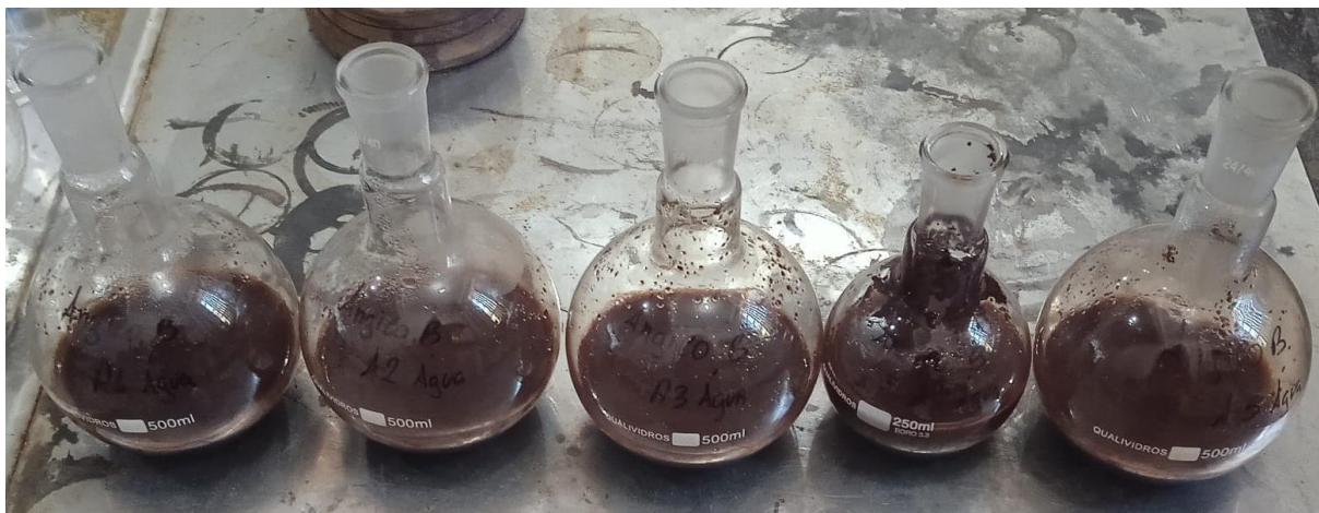
Figura 6: Tratamentos com diferentes porcentagens de sulfito de sódio ( \text{Na}_2\text{SO}_3 ).
