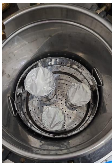
Figura 8: Extração de tanino em autoclave vertical. Fonte: Autor (2024).
