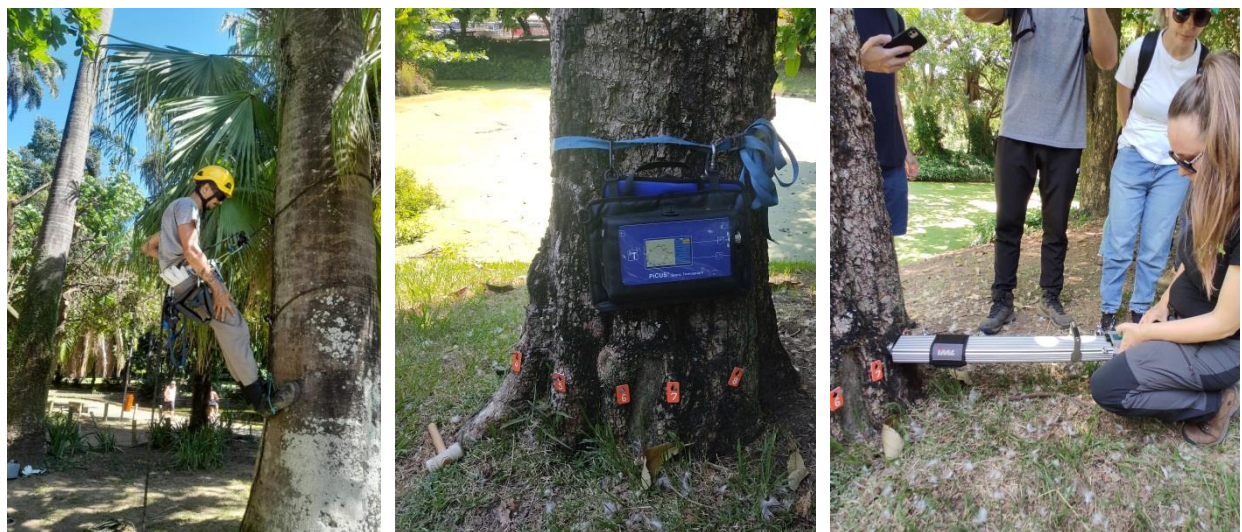
Figura 3 - Exemplos de Inspeção Nível 3: a) Escalada arbórea para detecção de defeitos na copa; b) Utilização de tomógrafo de resistência e ; c) Demonstração da utilização do resistômetro para avaliações de resistência do lenho. Fonte: Ochoski, 2024.
