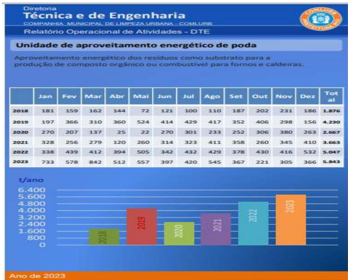
Figura 26. Aproveitamento energético dos resíduos de poda urbana do Município do RJ como substrato para compostagem ou combustível para fornos e caldeiras (t) / ano. Fonte: COMLURB - Relatório Diretoria Técnica de Engenharia – DTE. Acesso em 20 de Fevereiro de 2024.
