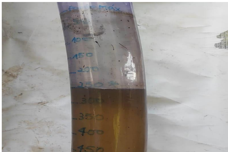
Figura 7. Mangueira transparente com 50 mm de diâmetro e com graduações a cada 50L.
