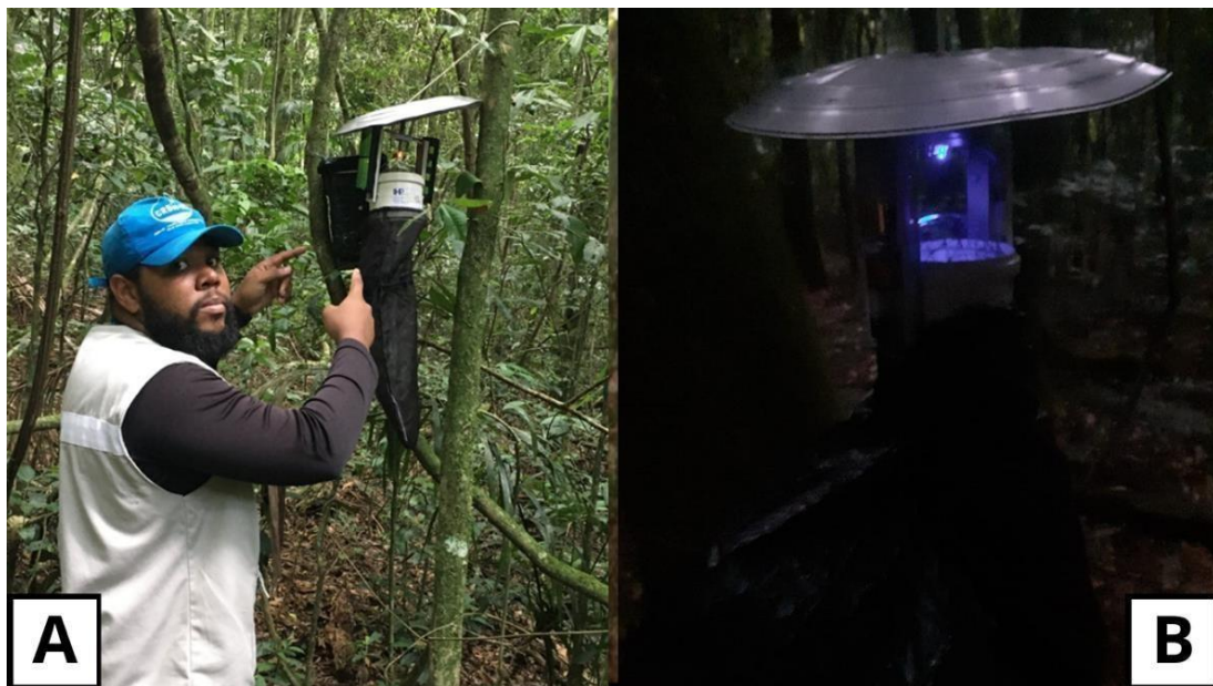
Figura 8. (A) Armadilha CDC funcionando durante o dia (B) Armadilha CDC noturna em funcionamento. Fonte: Nilton Henrique F. do Nascimento.
