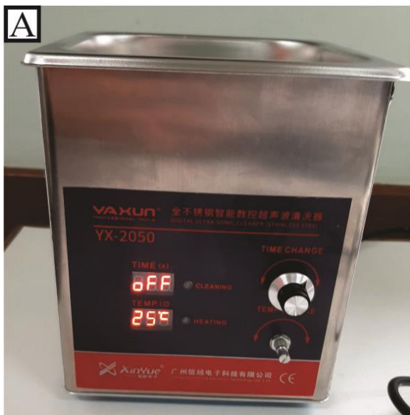
Figura 5: A) Ultrassom utilizado para a limpeza das amostras laterais e de calha dos poços estudados. B) Limpeza da amostra lateral A-3 (poço A).
