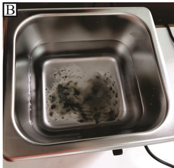
Figura 5: A) Ultrassom utilizado para a limpeza das amostras laterais e de calha dos poços estudados. B) Limpeza da amostra lateral A-3 (poço A).
