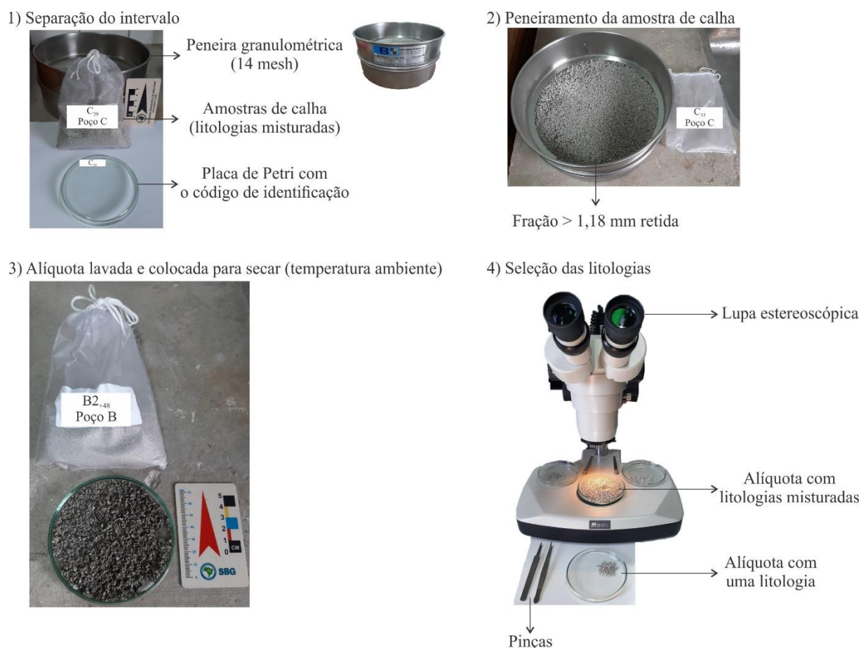
Figura 4: Esquema da metodologia e materiais utilizados na seleção das amostras de calha.
