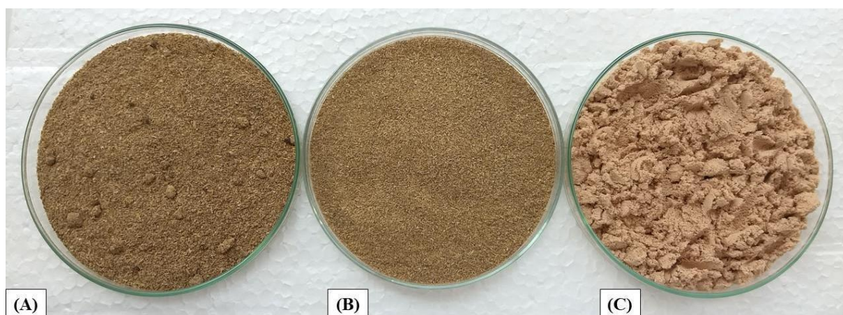
Figura 5. Resíduos cervejeiros avaliados na pesquisa: (A) Bagaço de malte antes do peneiramento; (B) Bagaço de malte após peneiramento (resíduo utilizado na pesquisa) e; (C) Terra de diatomáceas residual – TDR.
