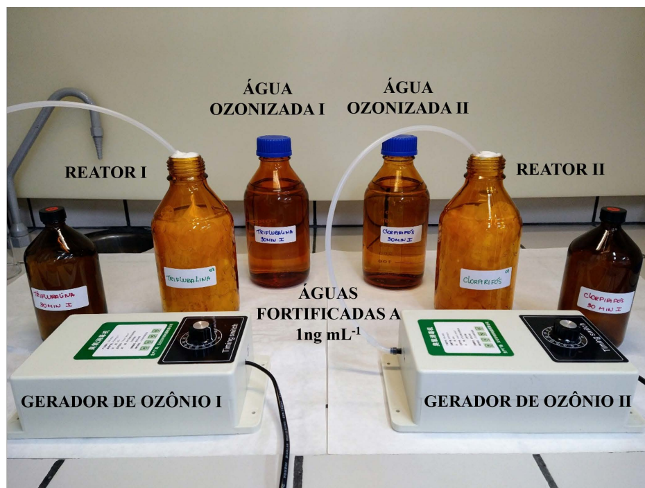
Experimento para degradação de agrotóxicos em água por ozonização Figura 10: Esquema degradação de agrotóxicos em água por ozonização
