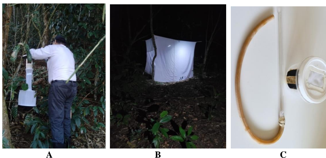
Figura 12 A. Instalação de armadilha luminosa de CDC B - Armadilha Shannon para captura de mosquitos. C – Armadilha de Castro e Gaiola para transporte dos mosquitos.
