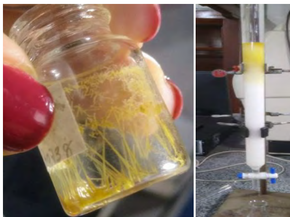
Figura 55 -Betuletol isolado da combinação das técnicas cromatográficas: HSCCC e GPC
