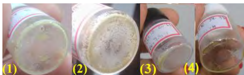
Figura 34 -Isolamento de (1) artepilina C, (2) mistura de triterpenos, (3) bacarina e (4) culifolina no fracionamento de própolis verde por CCC.
