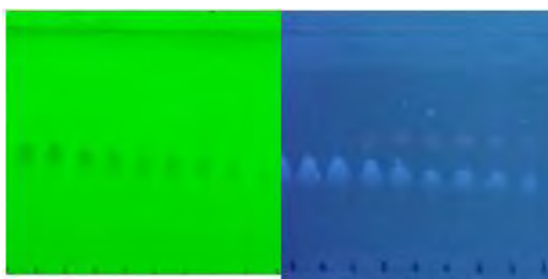
Figura 58 -Resultados de CCD de ácido anacárdico purificado visualizados sob luz UV ( \lambda = 254 nm) e luz UV ( \lambda = 365 nm).
