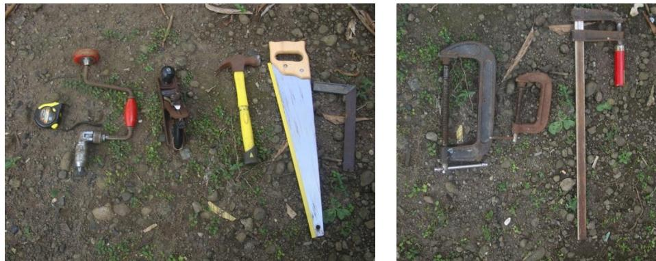
**Imagen 37. Ferramentas manuais de construtores *raizais***
