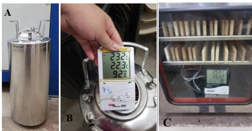
Figura 3. Demonstração do postmix utilizado para o processo de umidificação e secagem da madeira. A: Postmix utilizado como câmara para controle de umidade durante o processo de
