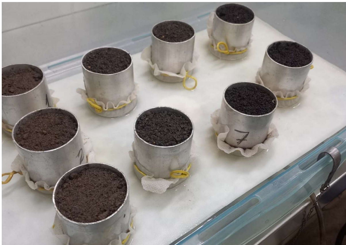
Figura 3. Cilindros para a mensuração dos parâmetros físicos dos substratos (capacidade de retenção de água, macroporosidade, microporosidade e porosidade total).
