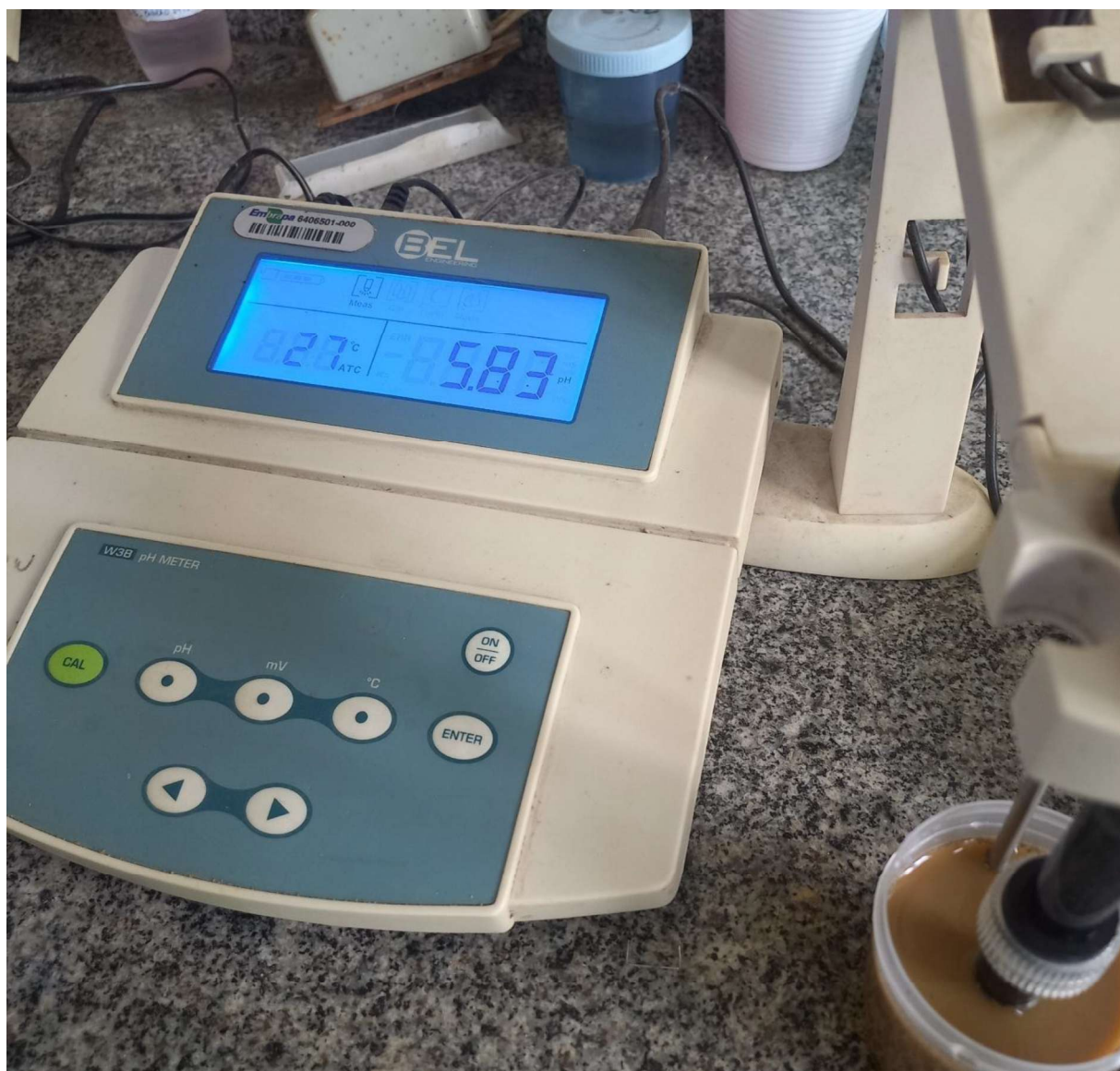
Figura 5. Medidor de pH para caracterização físico-química dos substratos analisados.
